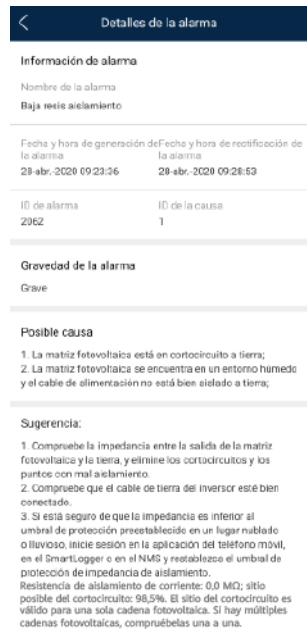
Figura E-1 Detalles de alarma
